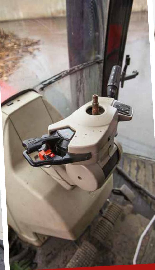
Fahrer Andreas Kraus hat dank Rückfahreinrichtung alles im Blick. Lenkrad und Armaturenbrett werden dazu einfach umgesteckt, die Pedalerie ist doppelt vorhanden.
