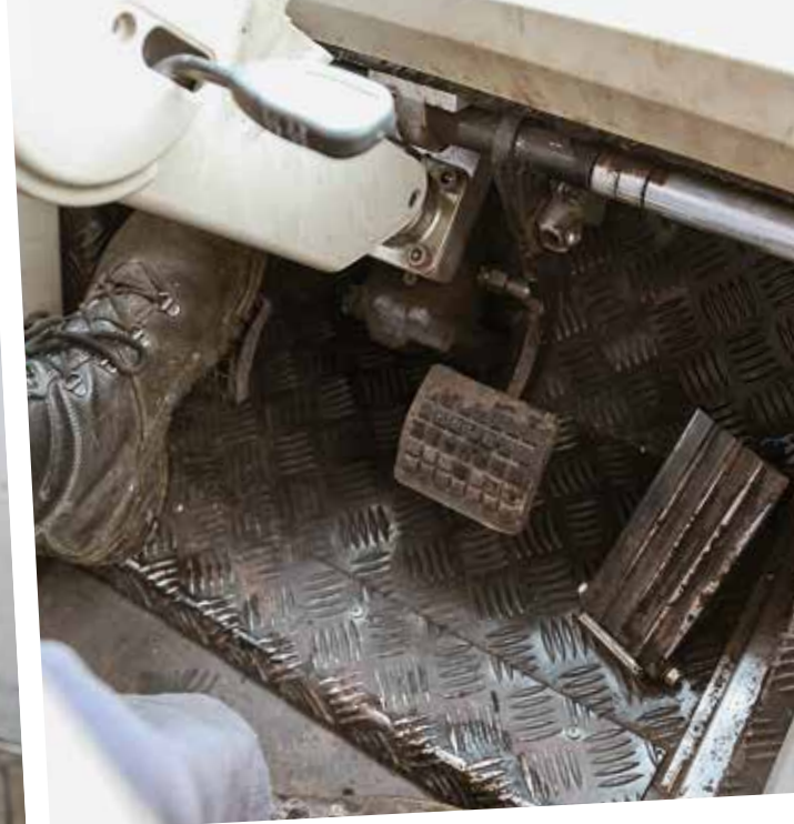
Fahrer Andreas Kraus hat dank Rückfahreinrichtung alles im Blick. Lenkrad und Armaturenbrett werden dazu einfach umgesteckt, die Pedalerie ist doppelt vorhanden.
