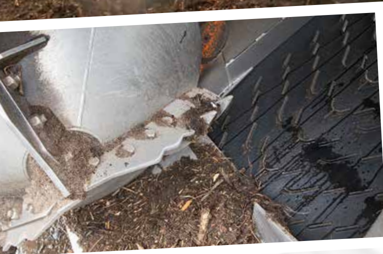
Die Frässscheiben sind mit Hartmetall bestückt und fördern das Material auf ein Förderband.
